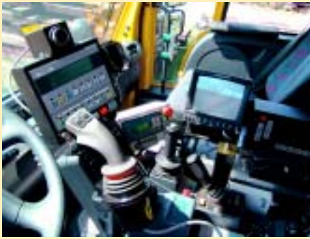
Das Cockpit des 2-Wege Unimog der AKN: Bedienpult der Schienenführung, Joystick für Bedienung der Arbeitsgeräte, Eisenbahn-Bremsventil, Totmannschalter, Zugfunkanlage etc.
